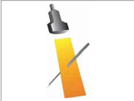
**Figura 8.** La imagen obtenida corresponderá a una sección transversal de la aguja y no a la punta de la misma.
