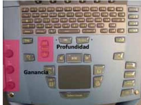
**Figura 2.** Ajustes de ganancia global, campo cercano, lejano y profundidad de exploración.
